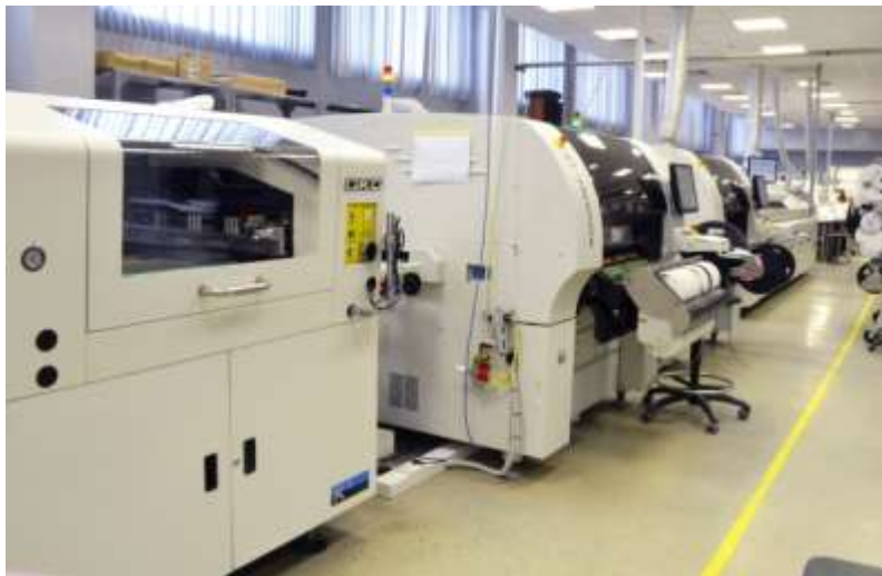
Цех монтажа SMD-компонентов
